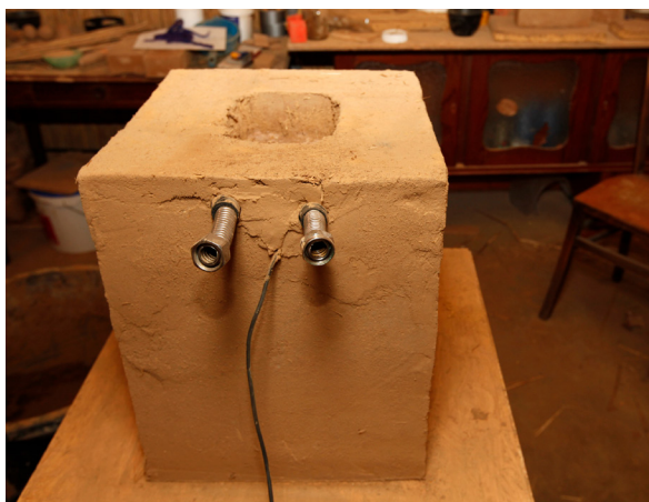
01 Der erste massive Lehmkörper mit integriertem Wärmeübertrager für Versuche zur solarthermischen Bauteiltemperierung aus dem Jahre 2008
